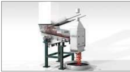
TOLVA DE DESCARGA
